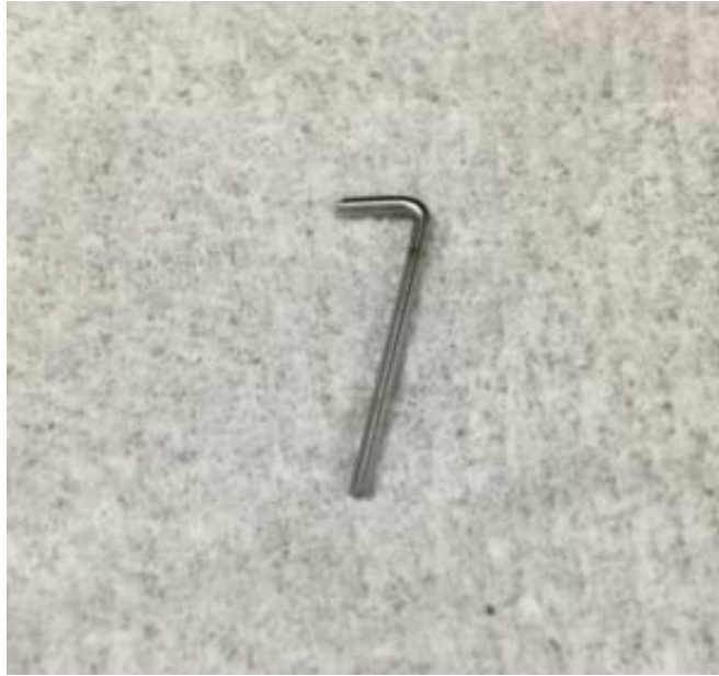
図 4-7 アンテナの外観
