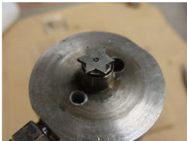
図 3.8 小型ホールスラストに設置されたアンテナ
