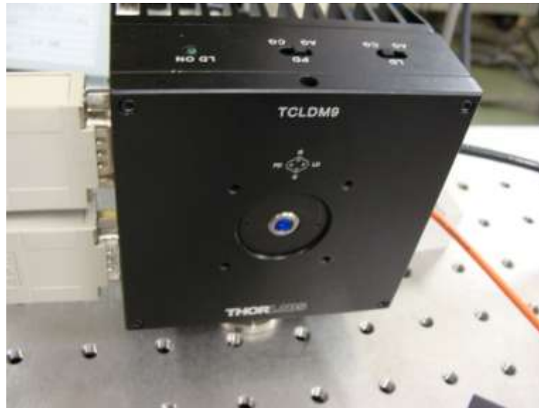
Fig.3.14 温度制御型レーザーダイオードマウント
