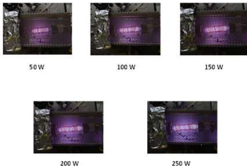
Fig.4.6 放電管外径 18 mm、銅線の太さ 1.0 mm におけるプラズマ写真
