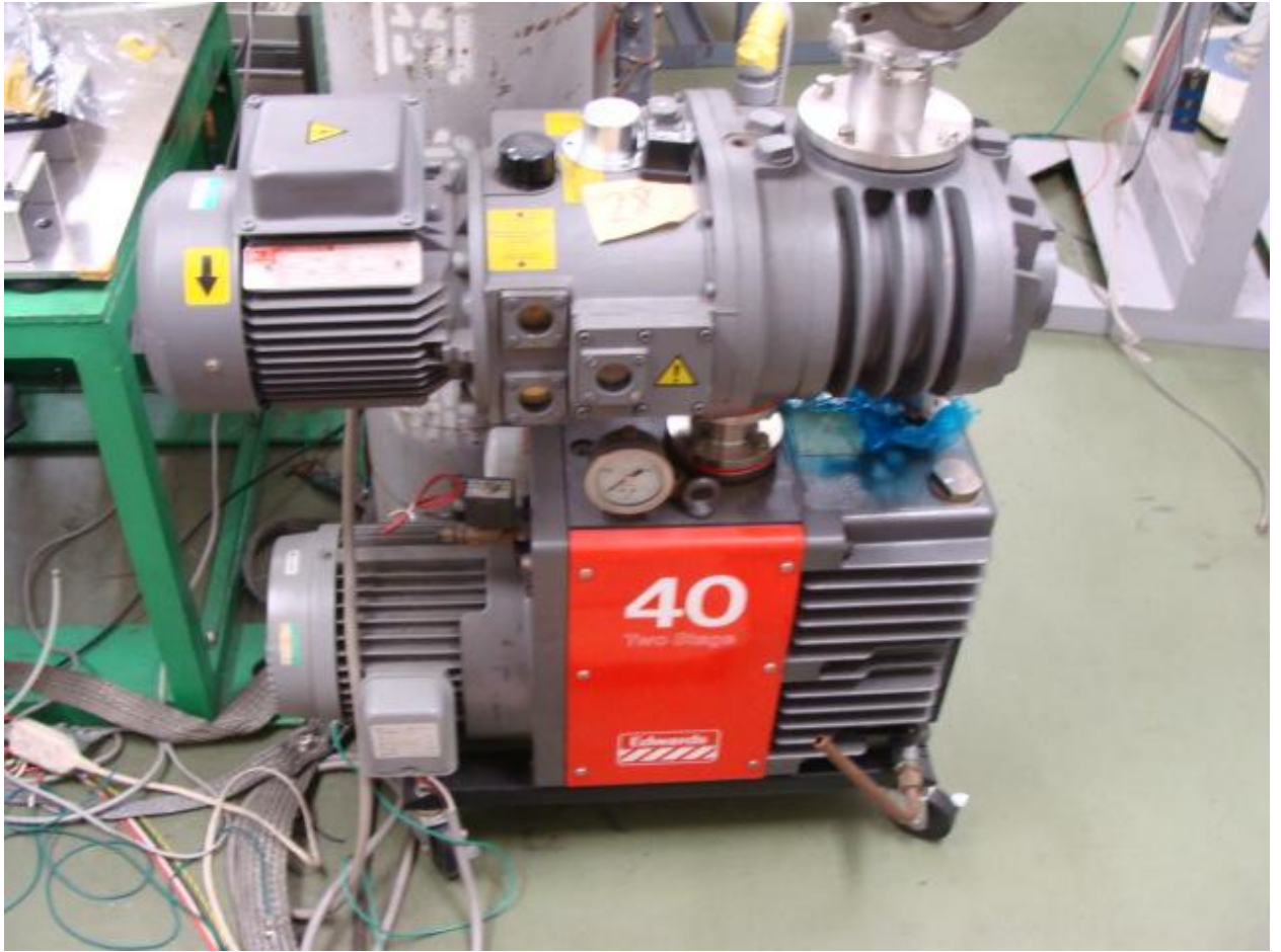
図 17 ロータリーポンプ(下)とメカニカルブースターポンプ(上)写真
