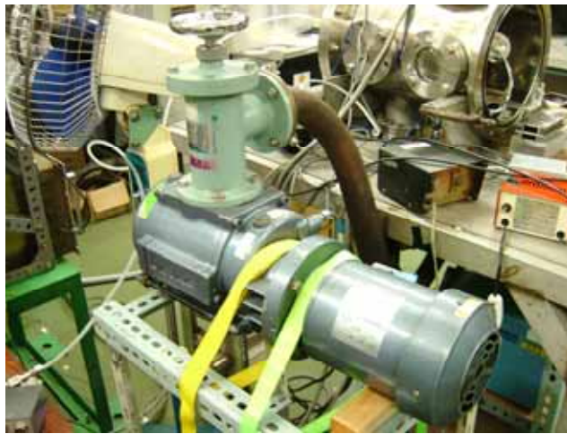
Fig.3-4 本実験で用いたメカニカルブースターポンプ
