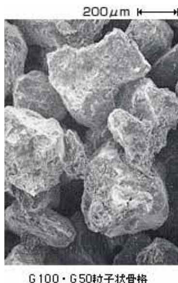
Fig.3-11 ポーラス状カーボンの SEM 写真
