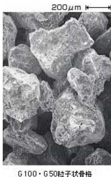
Fig.3-11 ポーラス状カーボンの SEM 写真
