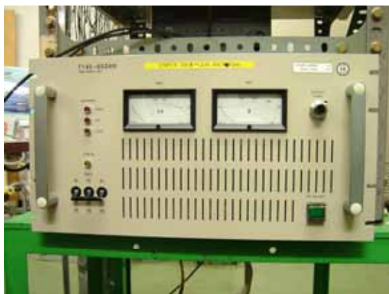
Fig.3-6 本実験で用いた高周波電源
