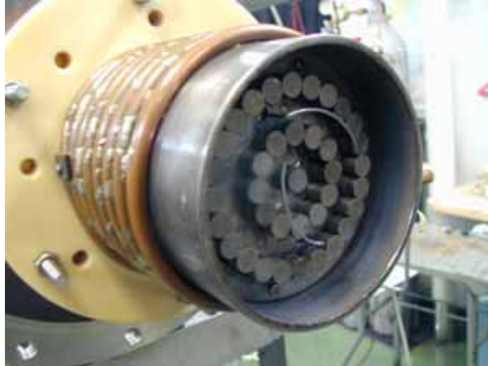
図 4.4 放電室の写真
